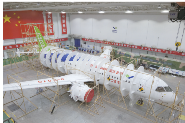
合肥航太团队在南昌进行C919大型客机全机雷电防护试验
