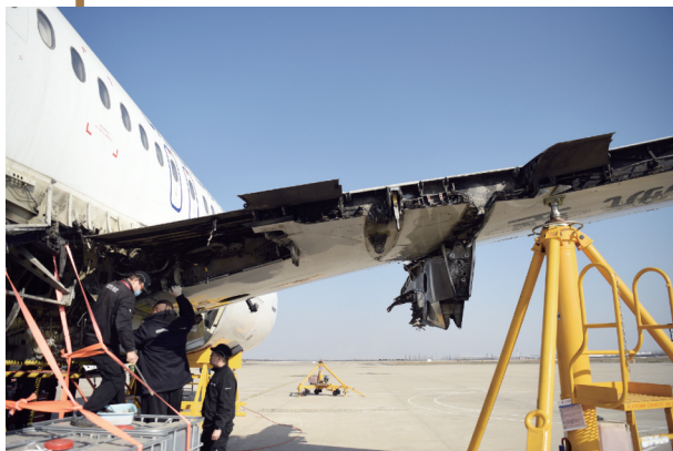
起落架已拆除,机翼被支撑起,保障后续拆解工作
