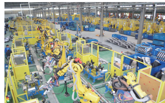
上海航空发动机制造有限公司滁州分公司汽车车体全自动焊接生产线
