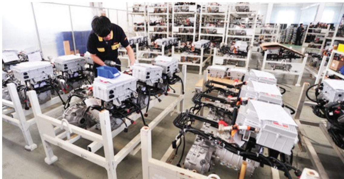
巨一自动化公司批量生产的IEV 6S电驱动系统
