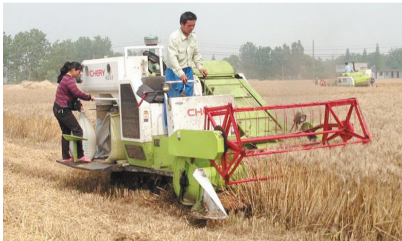
加装了秸秆粉碎装置的收割机在工作中
