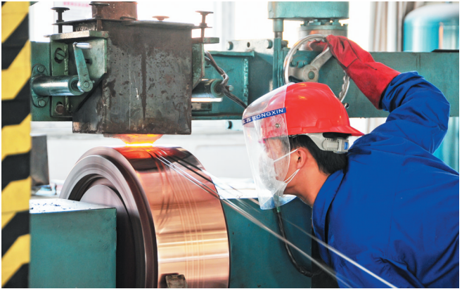
安庆天瑞新材料科技公司工作人员操作重力喷带机，机器喷出的非晶材料是制作磁芯的原料，该公司拥有我省第一条压力式喷带生产线。
