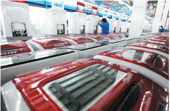
安徽金帅洗衣机有限公司，一台台洗衣机从流水线上安装成型。
