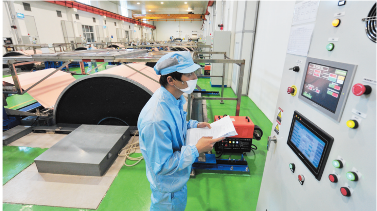
池州市安徽铜冠铜箔公司，无尘环境下生产加工电子铜箔，铜箔是电路板上覆铜板的基础材料。
