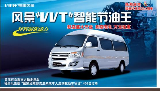
采用顶级连花公司开发的2.0VVT动力,功率高达95kW,百公里经济油耗仅8.6升,利用PVC进气歧管和脉冲增压进气增大进气量,单缸四气门,双顶置凸轮轴,燃烧更充分,升功率高达47.5kW/L,顶级Bosch爆震传感器,达 到最低的油耗。
